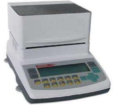
Вначале прибор определяет массу образца на весовой чаше, затем быстро нагревает образец посредством двух галогенов. Влага в исследуемом веществе испаряется, и вес образца изменяется. Анализатор влажности показывает изменение массы образца в процессе сушки. По окончании высушивания результаты измерений выводятся на дисплей.
