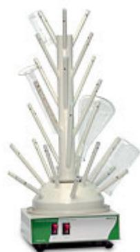
Назначение: быстрое просушивание химической посуды в потоке теплого воздуха.
