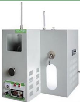
Аппарат ПЭ-7510 – прибор нового поколения, разработанный в соответствии с требованиями, предъявляемыми российским и международными стандартами к конструкции аппаратов и условиям определения фракционного состава нефти и различных групп нефтепродуктов при атмосферном давлении. ПЭ-7510 полностью соответствует ГОСТ 2177 (методы А и Б), EN ISO 3405, ASTM D 86, IP 123 и также может применяться для пробоподготовки по методам ГОСТ 19932, ASTM D 189, ISO 6615, IP 13.
