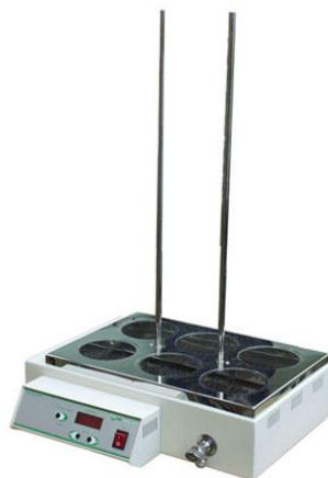
Баня лабораторная шестиместная предназначена для проведения химических, биологических, фармацевтических процессов, требующих нагрева при постоянной температуре в диапазоне от температуры окружающей среды до 100<sup>0</sup>С в лабораторных условиях.
